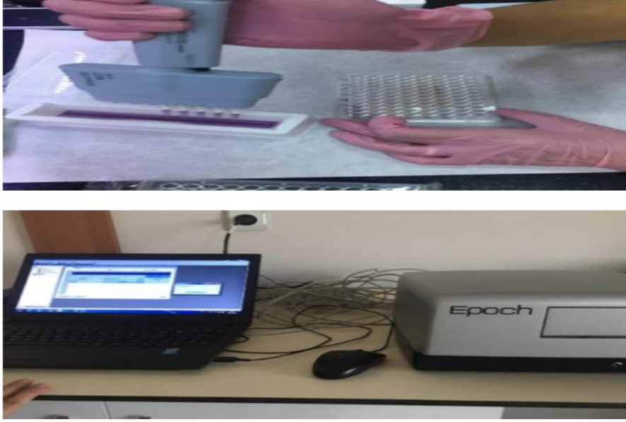
Şekil 5. DPPH radikali süpürme aktivitesi için deney ortamının hazırlığı ve Elisa cihazında okunması.
